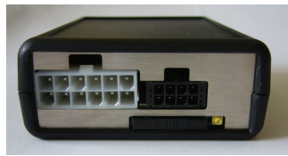
konektor K1 - hlavní konektor číslování pinů - pohled do konektoru zařízení čísle pinů nemusí souhlasit s čísly na výkresu
